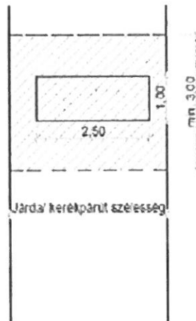
Új burkolat 5 éven belüli bontásnál - járda/kerékpárút
